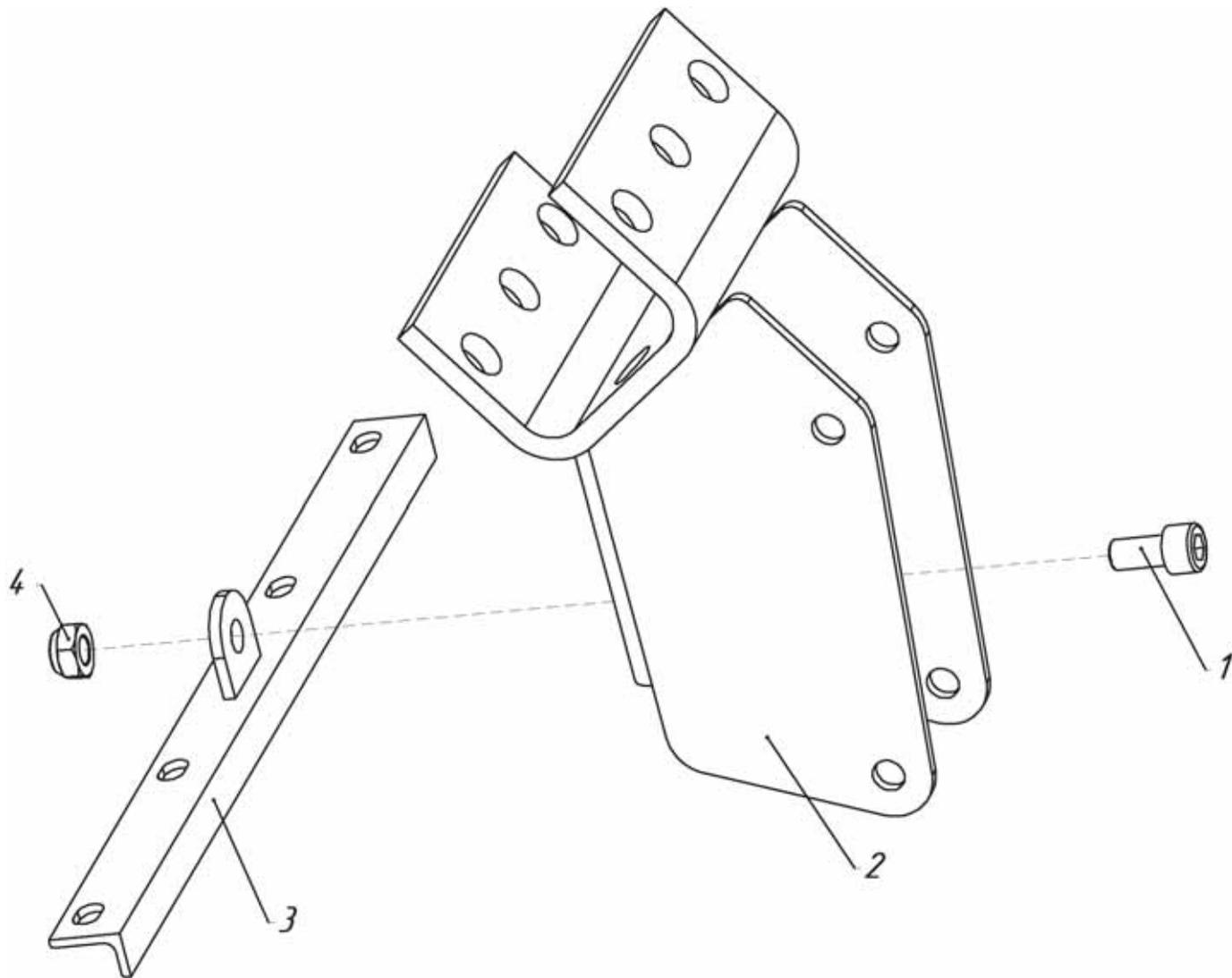
**Рис.6 (005.67.0010-04 Сцепное устройство)**
