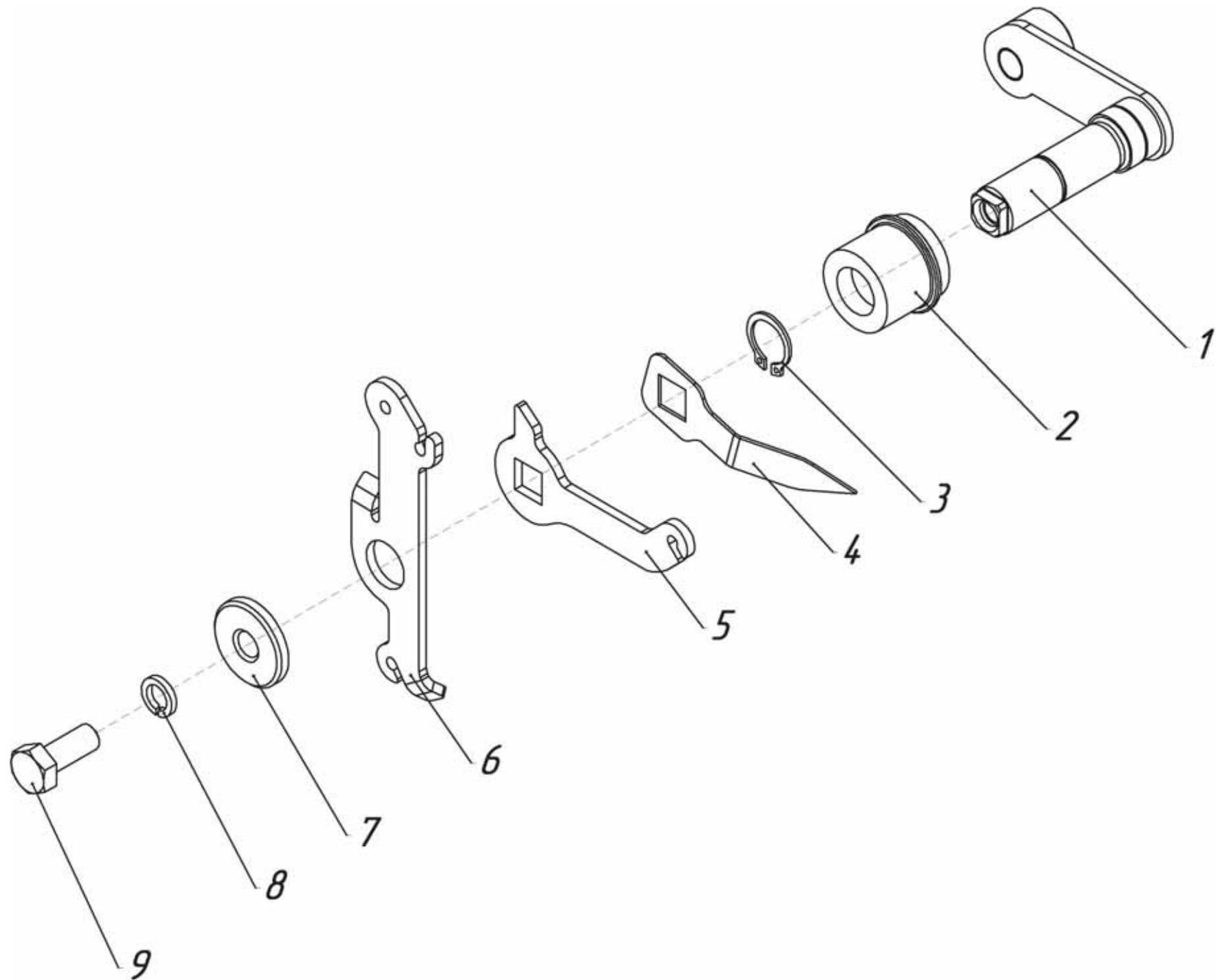
Рис.11 (005.67.0640-02 Рычаг переключателя)
