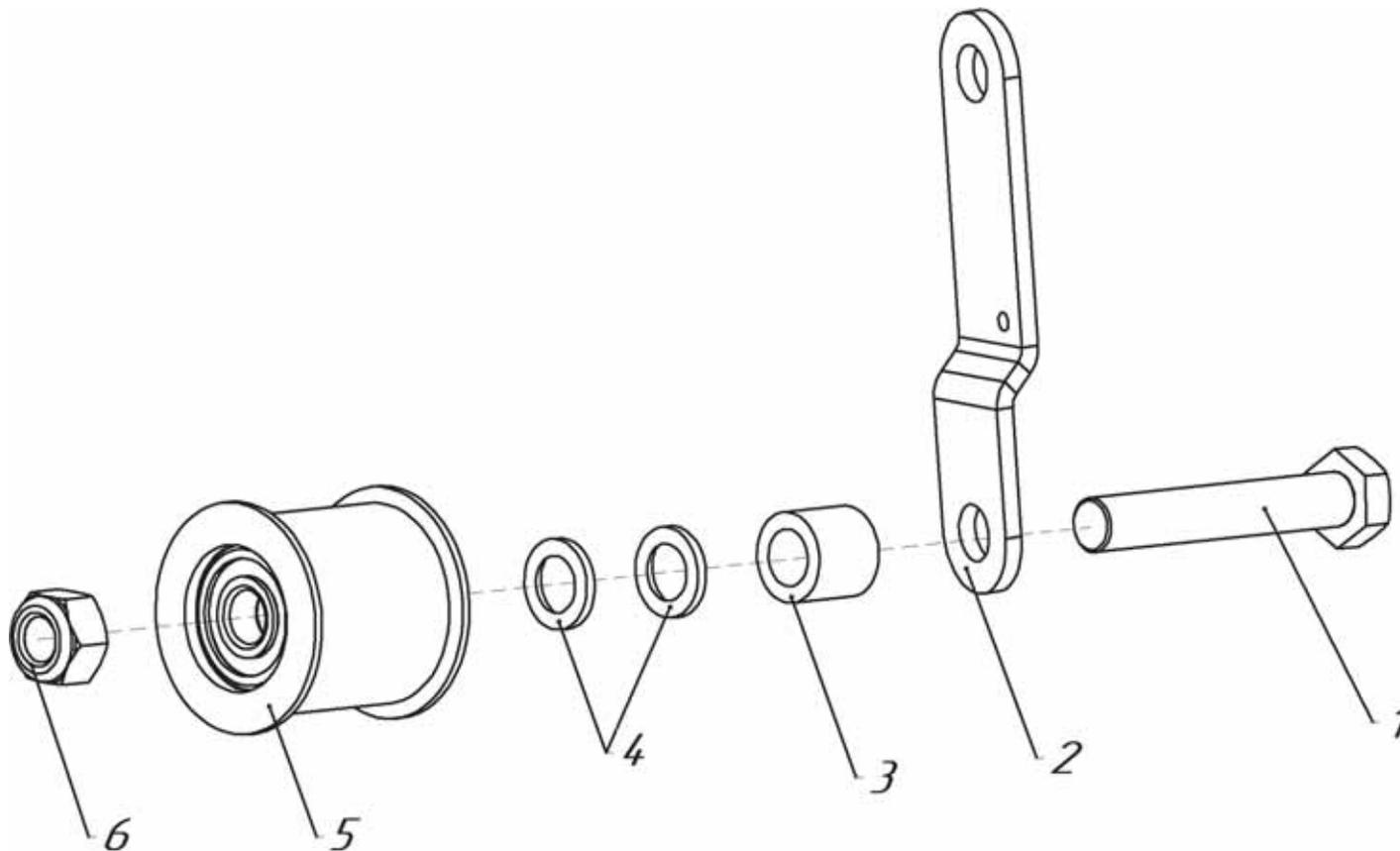
**Рис.5 (005.67.0150-10 Ролик натяжной)**
